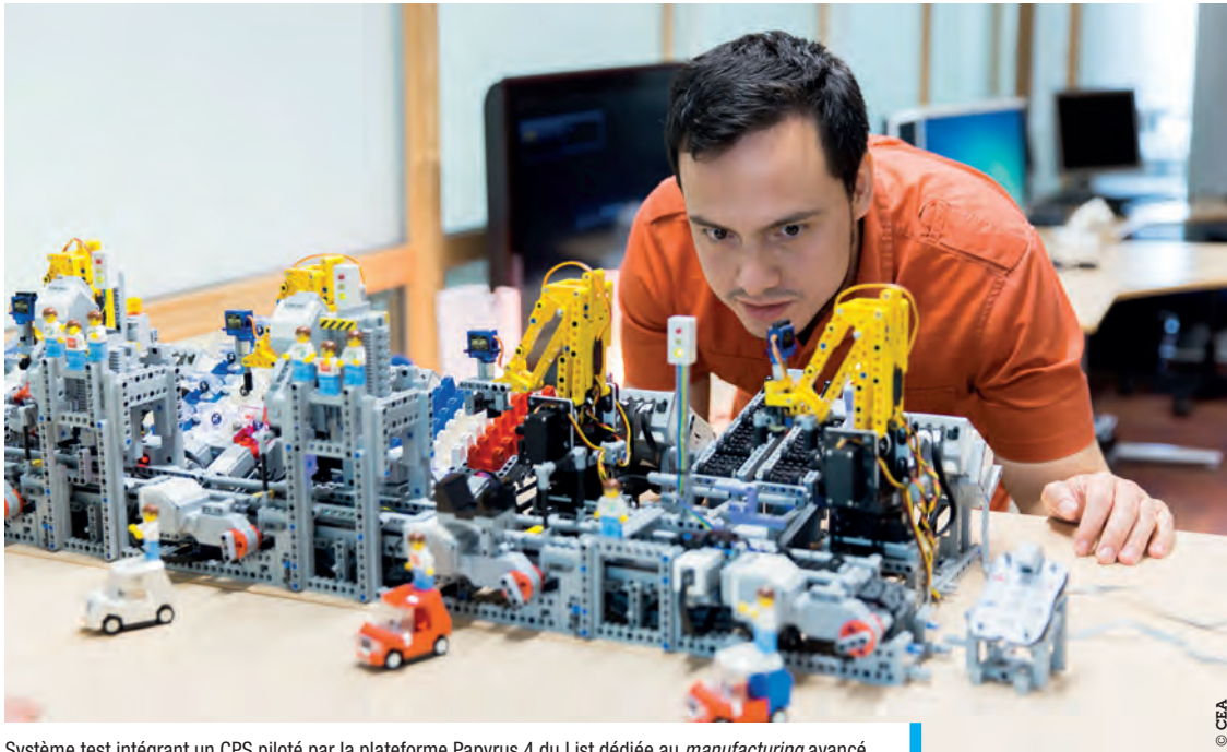
Système test intégrant un CPS piloté par la plateforme Papyrus 4 du List dédiée au manufacturing avancé.
