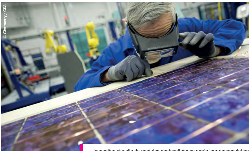
Inspection visuelle de modules photovoltaïques après leur encapsulation.
