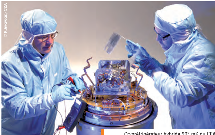
Cryoréfrigérateur hybride 50° mK du CEA, conçu pour les projets Athéna et Spica-Safari.
