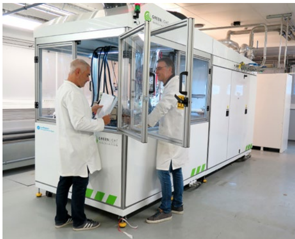
La plateforme PEMFC monte en puissance avec l'acquisition d'un banc de test 100 kW.
