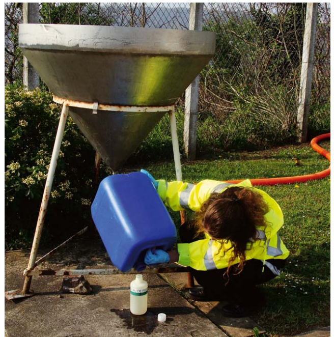
Prélèvement hebdomadaire des eaux de pluie obtenues grâce aux récolteurs. © F. Genest/CEA
