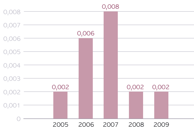
Diagramme n°2 : Évolution de l'activité totale alpha (GBq) dans les rejets liquides de 2005 à 2009.
