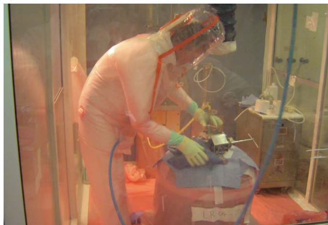
Opérateur en tenue ventilée intervenant sur le conteneur de relevage de l'installation Pétrus. © CEA
