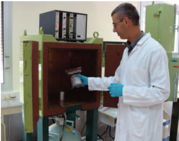
Mise en place d'un échantillon pour mesure de la radioactivité par spectrométrie gamma
