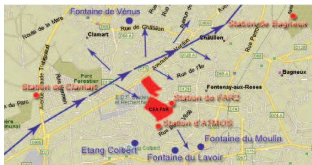
Figure n° 3 : Implantation des stations de contrôle de l'environnement (les flèches bleues indiquent la direction d'écoulement de la nappe phréatique)
