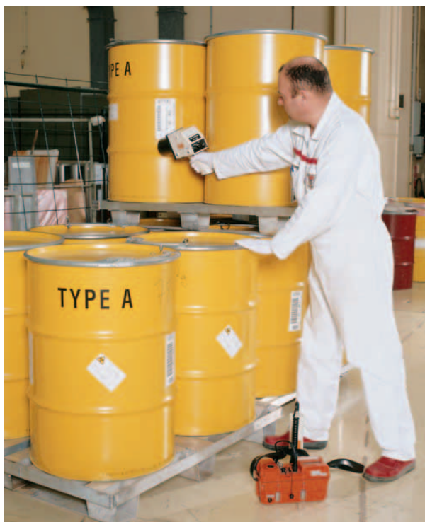
Contrôle radiologique de fûts de déchets de faible activité
