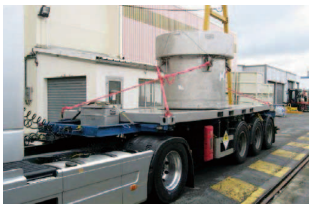
Préparation de l'expédition d'un conteneur de transport de fûts de déchets (DGD)
