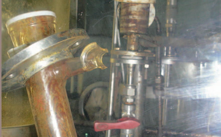
Rupture d'une vanne dans la boîte à gants Prodiges en octobre 2008
