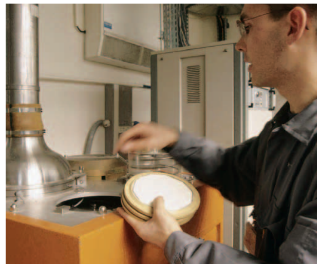
Prélèvement de filtres pour mesures en laboratoire
